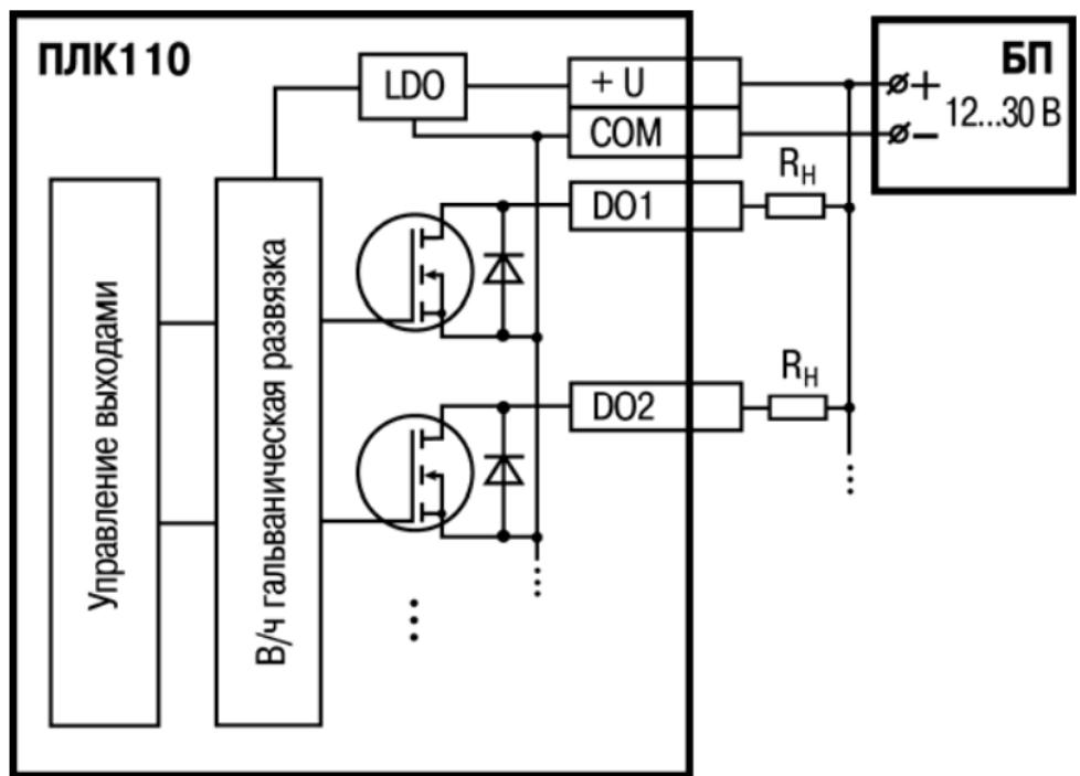
Рисунок В.5 – Выходные элементы типа К (быстродействующие) контроллера
