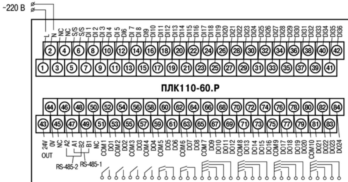
Рисунок Б.1 – Схема расположения и назначение клемм на ПЛК110-220.60.Р. Схема для ПЛК110-24.60.Р – аналогична
