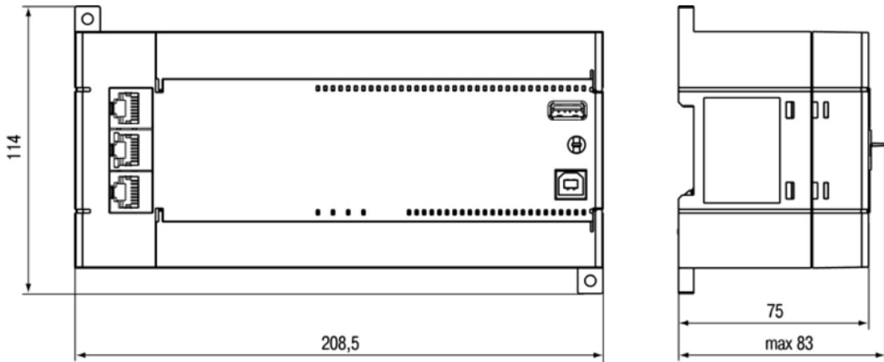
Рисунок А.1 – Габаритные размеры ПЛК110.Х.60.Х-Х
