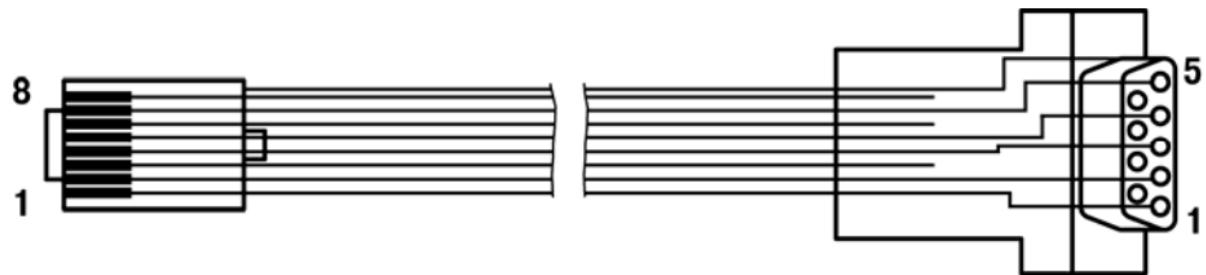
Рисунок Г.1 – Схема кабеля программирования КС14, входящего в комплект поставки
