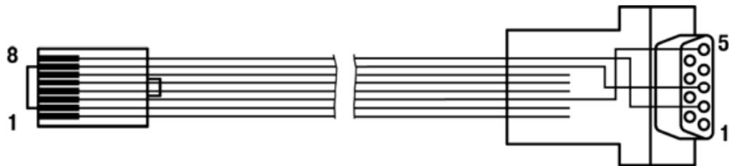
**Рисунок Г.3 – Схема кабеля КС16**
