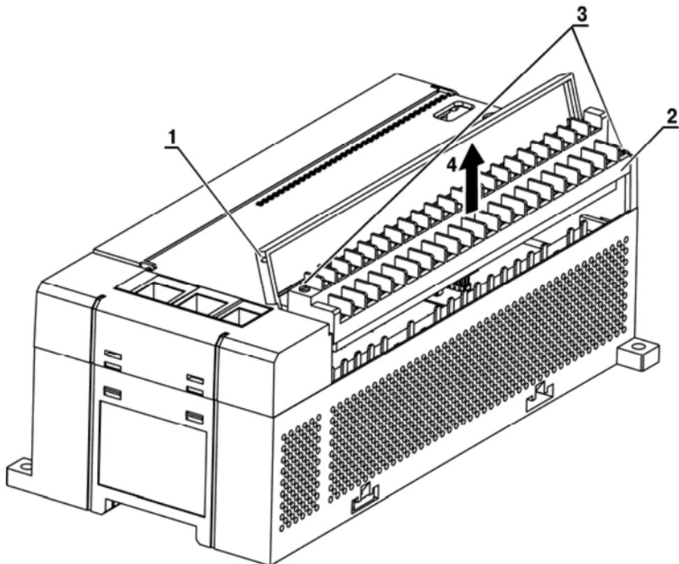
Рисунок Д.1 – Отсоединение клеммных колодок контроллера
