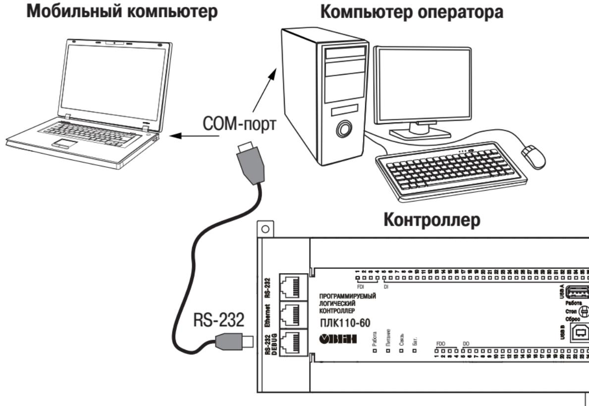
Рисунок 4.1 – Вариант подключения к ПК для программирования контроллера через порт Debug RS-232
