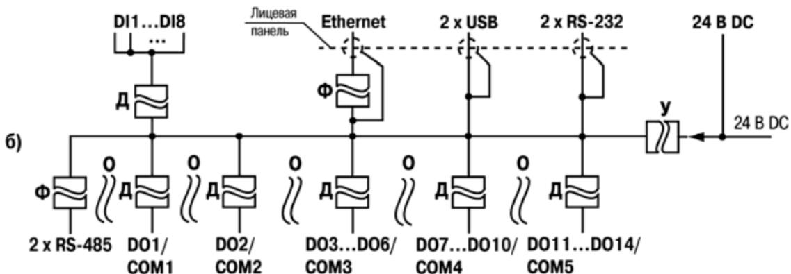
Рисунок 2.2 – Схема электрической прочности изоляции ПЛК110-220.х.К (а) и ПЛК110-24.х.К (б)
